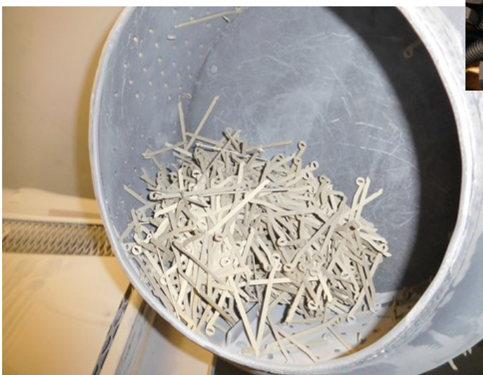
Bęben do korundowania drobnych elementów
